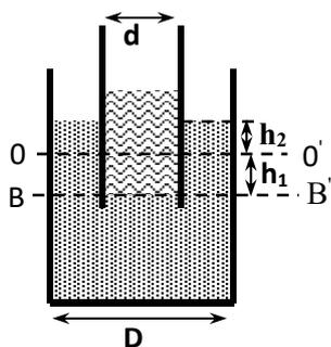
Запишем условие равновесия жидкости на уровне  $BB'$  и условие несжимаемости жидкости.
