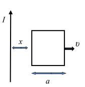
Примечание: магнитная индукция бесконечного проводника при прохождении через него тока определяется по формуле  $B(x) = \frac{\mu_0 I}{2\pi x}$ .
