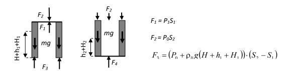
F<sub>4</sub> – сила атмосферного и гидростатического давления на дно трубы.
