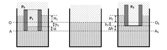
1. Так как трубка плавает в сосуде, то сила тяжести уравновешивается силами давления со стороны жидкости и газа.  $F_2 + mg = F_3 + F_1$ ,  $F_2 + mg = F_4$ , где  $F_1$  – сила давления сжатого газа на внутреннее сечение трубы,
